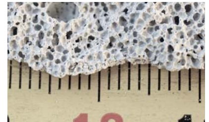
i06. Muestra de hormigón curado en autoclave.
