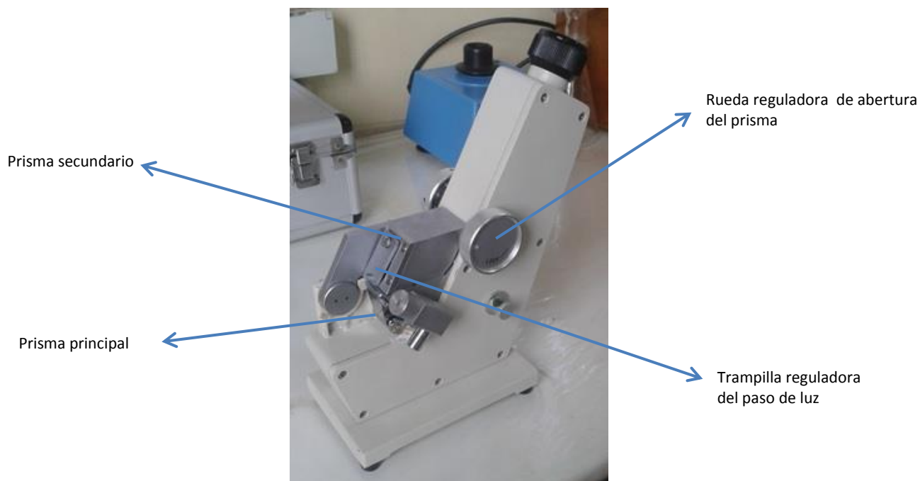
Figura 37. Trampilla reguladora del paso de luz y prismas en un refractómetro.
