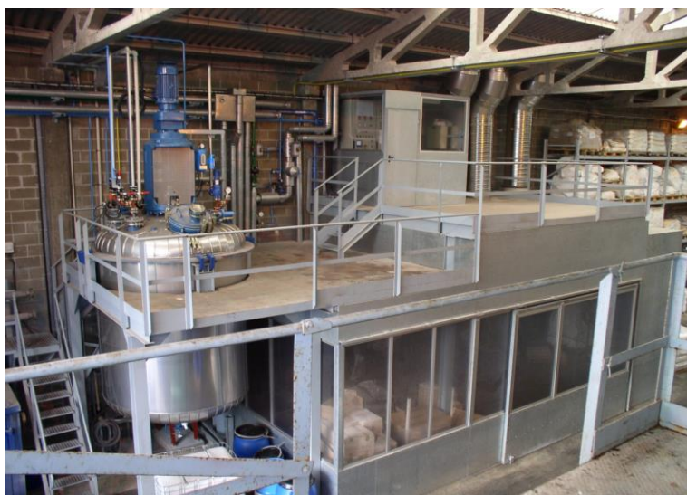
Figura 11. Planta de fabricación de Monoperoxifitalato de Magnesio.
