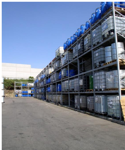
Figura 7. Sistema de almacenamiento de materias primas y sustancias no peligrosas envasadas.
