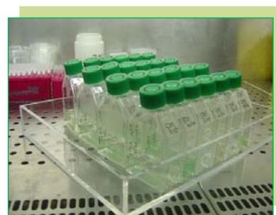
Figura 3. Caja de metacrilato y posición de los frascos Greiner durante la irradiación.
