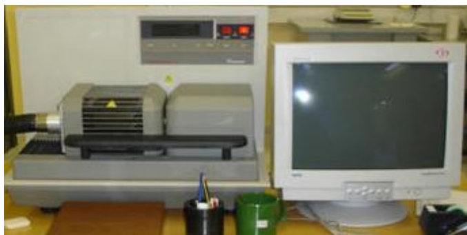
Figura 3.5. Analizador simultáneo TGA-DTA ThermalAnalysis SDT2960.
