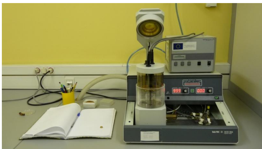
Figura 3.4. Equipo de pulverización catódica BAL-TEC SCD-004.
