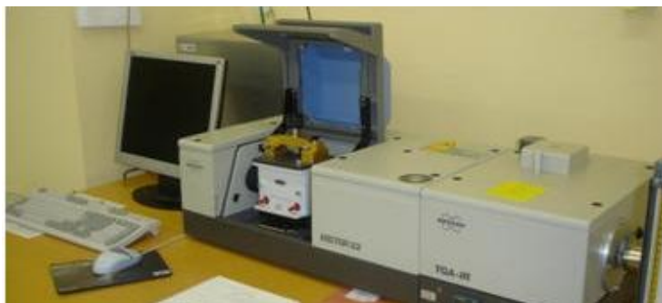
Figura 3.7: Espectrómetro de IR Bruker VECTOR22
