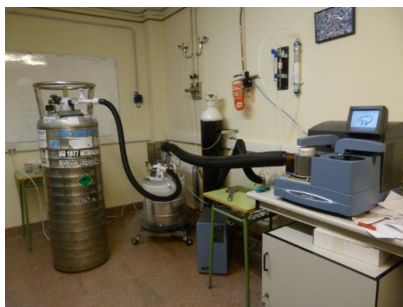
Figura 3.10. Equipo DSC modelo Q1000.
