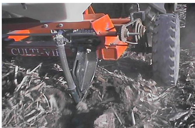
Subsolador de hoja delgada con distribuidor de yeso en profundidad.
