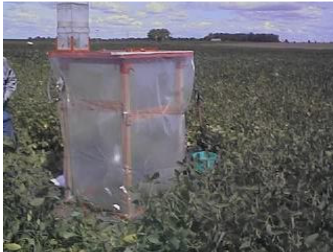
Figura 9. Simulador de lluvia portátil de placa con goteros.
