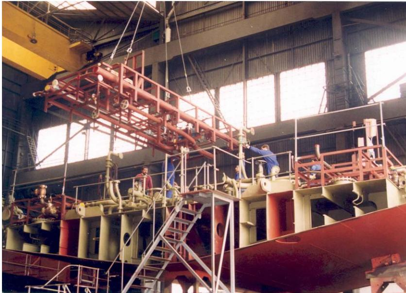
**Figura 5-18: Montaje de módulo en el bloque**
