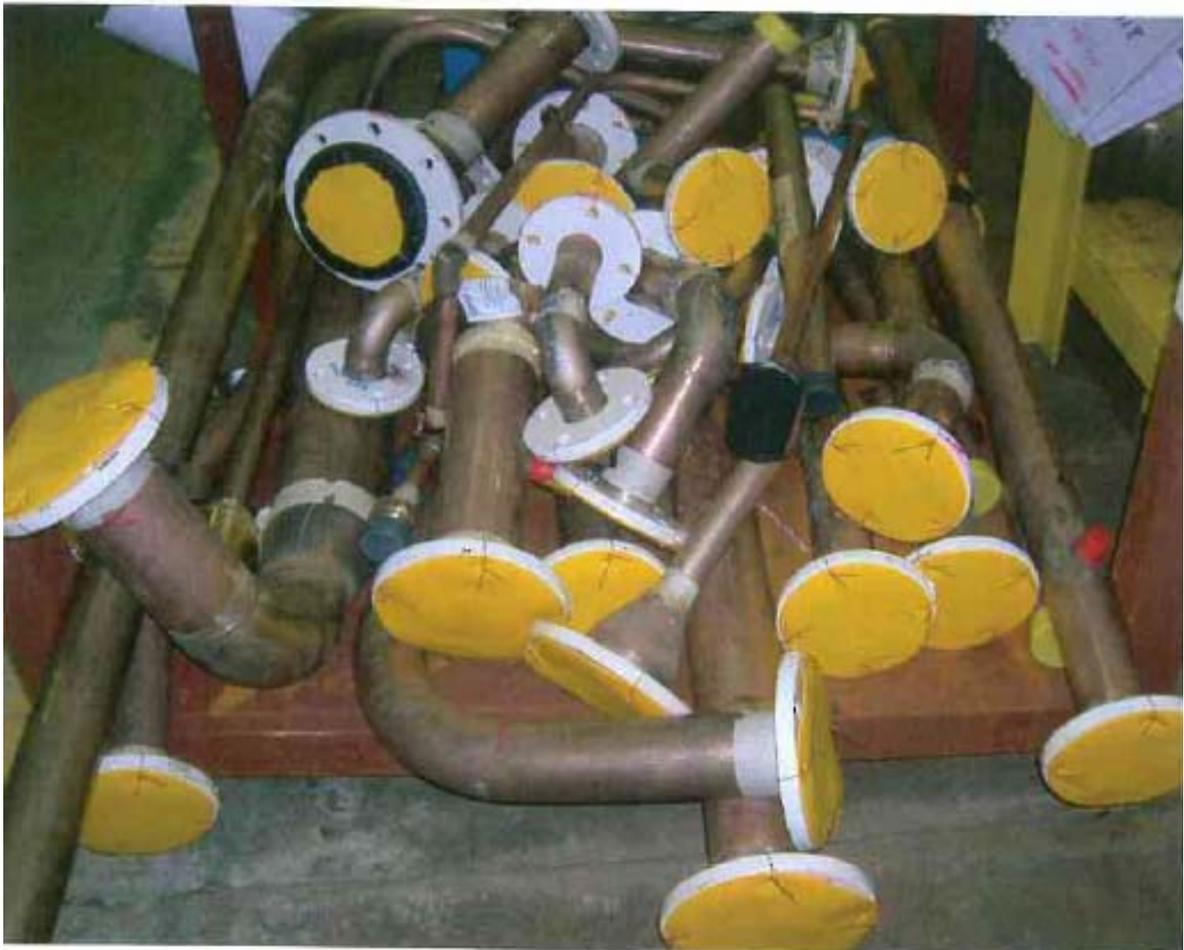
**Figura 4-16: Forma adecuada de estibar la tubería**
