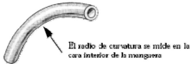
**Figura 5-23: Radio de Curvatura**
