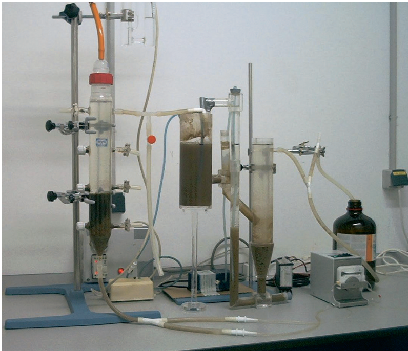
Figura 7.2. Fotografía del sistema pre-desnitrificante.
