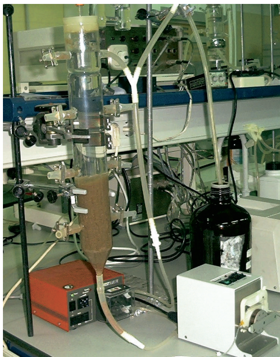
Figura 4.2. Fotografía del reactor anóxico de tipo USB.
