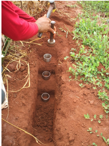
Figura 3 - Coleta de amostras de solo com sua estrutura preservada com o auxílio do anel de Kopect.
