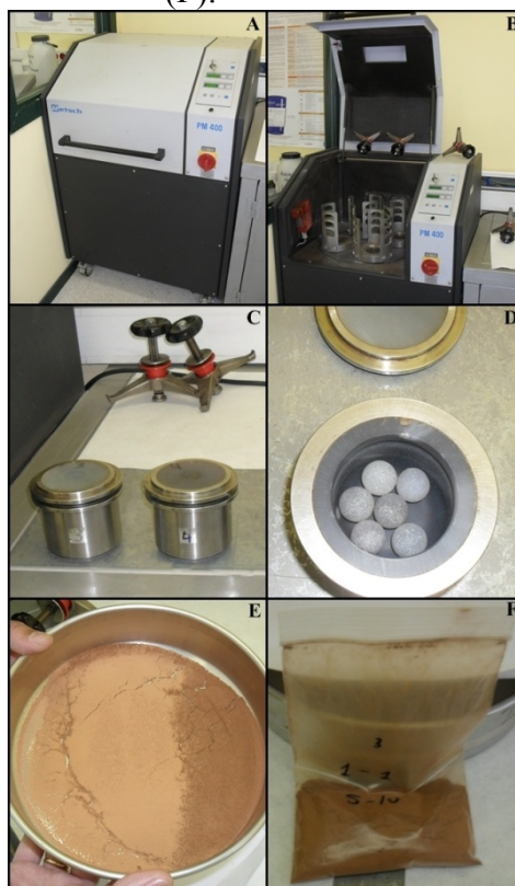
Figura 41 - Moinho de bolas Retsch, modelo PM 400 (A); visão interna do moinho de bolas Retsch, modelo PM 400 (B); recipiente de moagem (C); detalhe do recipiente com as bolas de moagem (D); solo peneirado à 125 \mu\text{m} (E); solo peneirado, homogeneizado e identificado (F).
