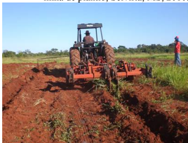
Figura 8 - Subsolador com uma única haste de 0,50 m utilizado na linha de plantio, Selvíria, MS, 2010.
