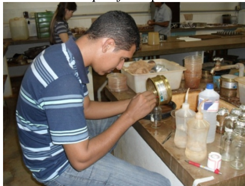
Figura 85 - Transferência da fauna epígea coletada nos pitt falls para o armazenamento em álcool 70 %.
