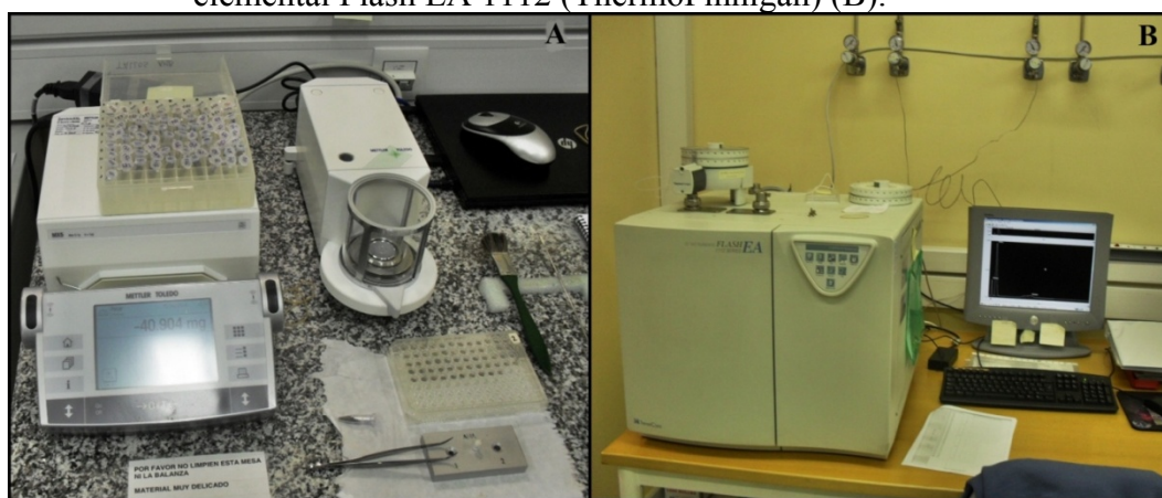
Figura 44 - Microbalança MX-5 (Mettler-Tolledo) com precisão de 1 µg (A); analisador elemental Flash EA 1112 (ThermoFinnigan) (B).
