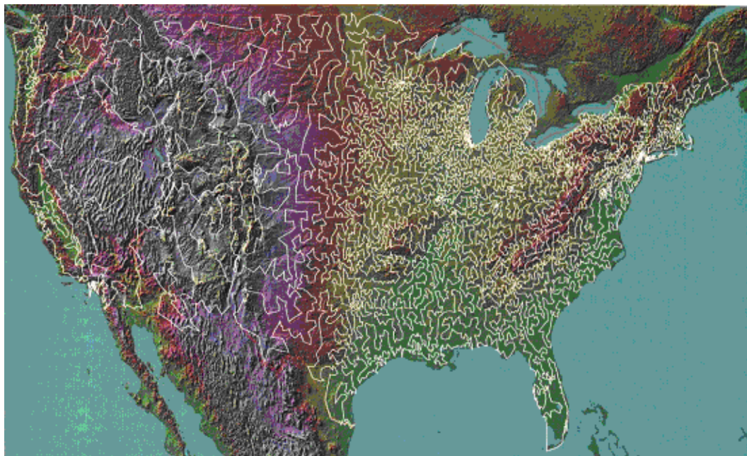
Figura 1.8 Solución al problema usa13509 del TSPLIB obtenida por Ch'vatal et al. utilizando el algoritmo CONCORDE.
