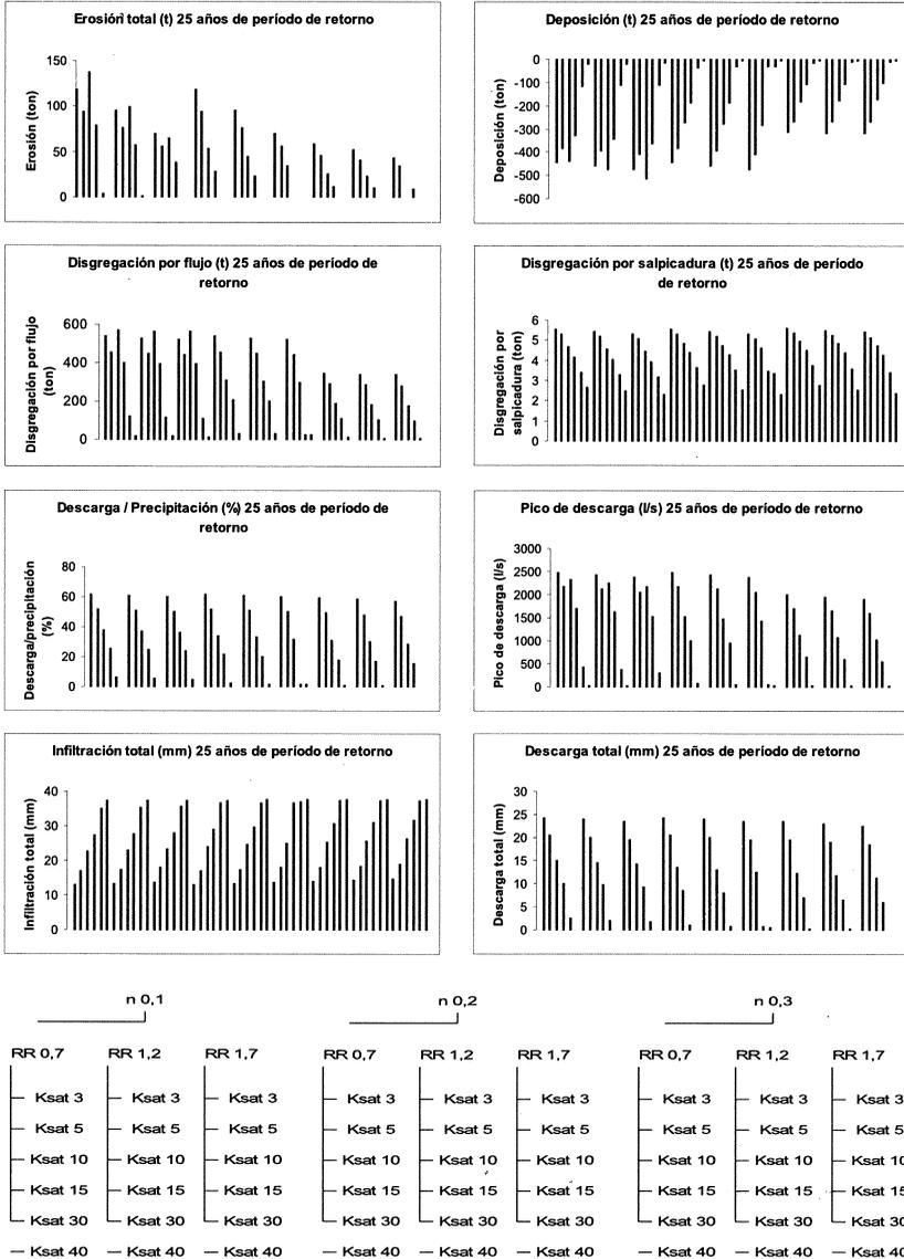
**Figura 3.** Gráficas con los resultados de las simulaciones para 25 años de periodo de retorno y organigrama adjunto de las simulaciones (de izquierda a derecha y de arriba abajo, se comienza por n 0.1 ; RR 0.7 y Ksat 3 y se termina por n 0.3; RR 1.7 y Ksat 40).
