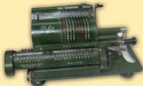
◀ Calculadora Rokli de fabricación alemana (c. años cuarenta y cincuenta). Calculadora mecánica de acción manual, basada en la rueda de dentición variable o de Baldwin-Odhner. Muy parecidas fueron las Minerva, producidas por la Fábrica de Artículos Mecánicos de Oficina, S.A., en el barrio de Les Corts de Barcelona, entre 1946 y 1969.
