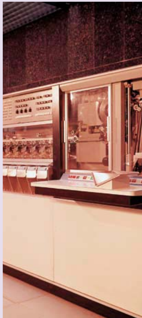
▲ Lectora-clasificadora de caracteres magnéticos IBM 1412. Cozó de gran aceptación en la banca norteamericana para la compensación de talones. La CPVA, pese a tenerla a prueba, la rechazó pues no se adaptaba a su operativa corriente.
