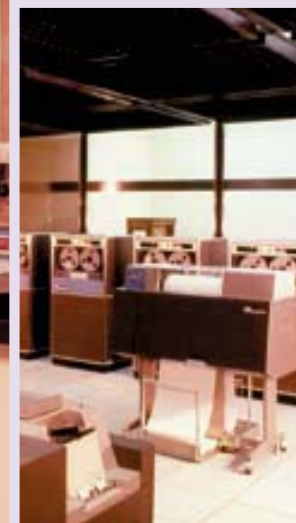
◀ En primer plano la lectora perforadora IBM 1402-2, en el centro de la imagen la impresora, al fondo, las cintas magnéticas.
