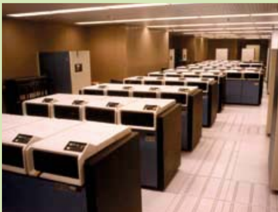
◀ Discos fijos IBM 3350 con una capacidad entre 600 y 1200 MB. Fueron los primeros discos fijos, es decir, no desmontables. Una fila de 8 discos de estas características tenía la capacidad de un pendrive actual que cuesta 5 euros. El disco fijo permitía trabajar con tolerancias más estrictas y sobre todo permitía poner la unidad hermética, aislándola de posibles contaminaciones.
