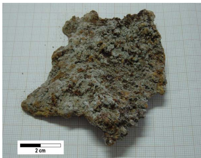
Figura 3.2. Costra de óxihidróxidos de Fe formada a partir de la oxidación de la granalla presente en los serrines cuando estos son expuestos a la atmósfera., manteniendo altos contenidos de humedad.
