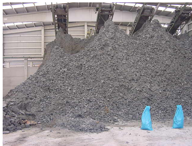
Figura 2.6. Acopio de serrines a la salida de los filtros-prensa de una explotación de O Porriño
