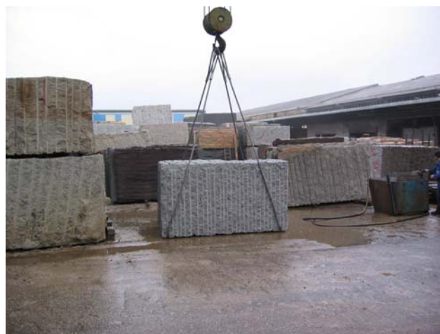
Figura 2.1. Bloque extraído de cantera antes de ser cortado en telar
