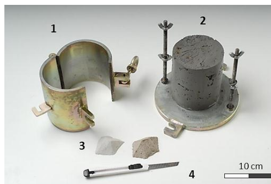
Figura A .5. Elementos del proceso de elaboración de muestras para escáner. [1] Molde próctor; [2] muestra de suelo compactado; [3] muestras para el escáner; [4] herramienta de corte.
