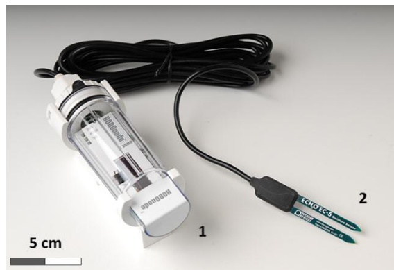
Figura 4.2. Sonda de capacitancia ECHO modelo EC-5. [1] Transmisor de señal inalámbrico; [2] Sensor de humedad.
