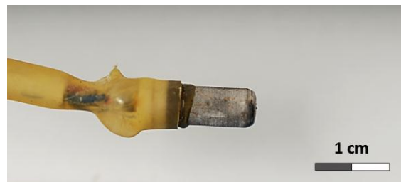
Figura 4.3. Psicrómetro de termopar con vaina porosa de acero inoxidable PCT-55-15-SF (Wescor Inc.)
