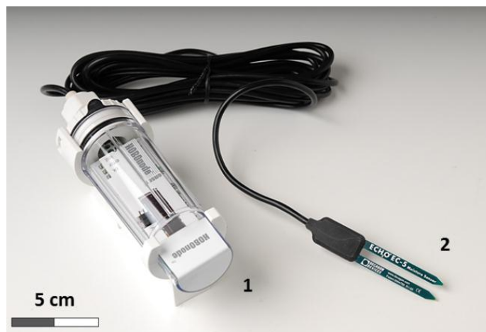
Figura A .12. Sonda de capacitancia ECHO modelo EC-5 ( Decagon Devices, Inc. ). [1] Transmisor de señal inalámbrico; [2] Sensor de humedad.
