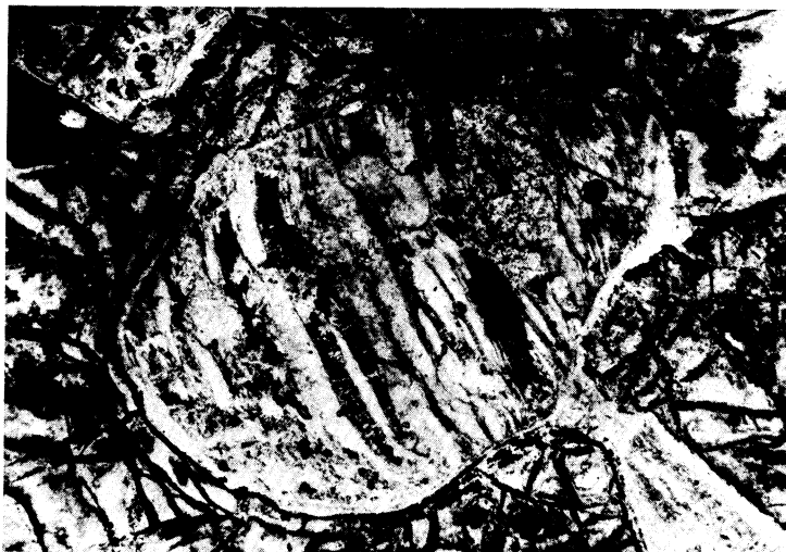
Fig. 6.- Roca granoblástica pseudomorfizada por minerales de bajo grado de carácter hidrotermal: clorita, óxidos, carbonatos (dolomita), cuarzo,... N// x10.
