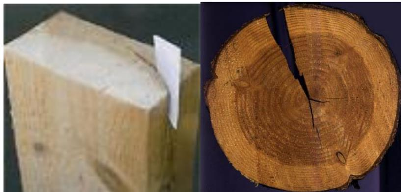
**Gemas o corte de arista truncada.** - Se denomina gema a la superficie redondeada original del tronco, con o sin corteza, que se manifiesta sobre la arista de la pieza de la madera aserrada.
