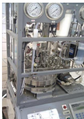
Figura 2: Electrolizador 1 kW en el laboratorio.
