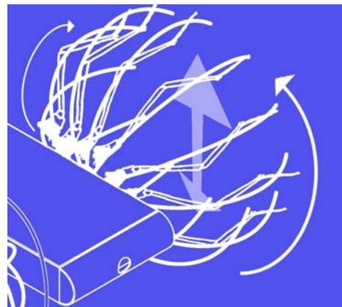
Figura 9: “Wheg” de aspas curvas simulando patas de insecto en una rueda.
