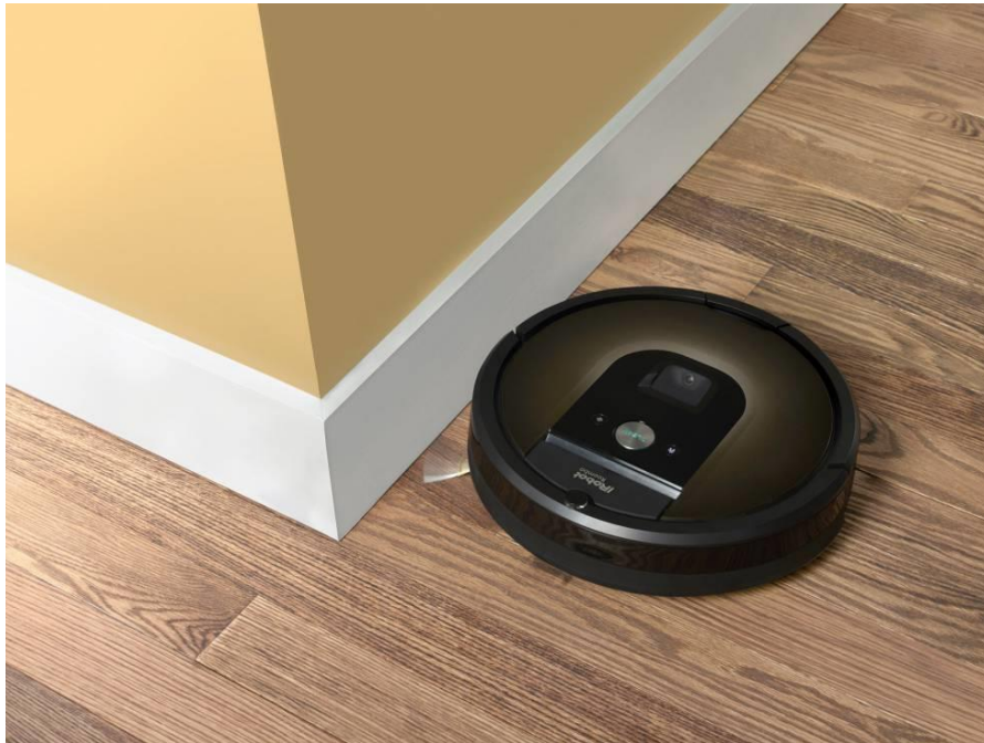
Figura 5: Roomba. Ejemplo de un robot autónomo capaz de orientarse mediante sensores de proximidad
