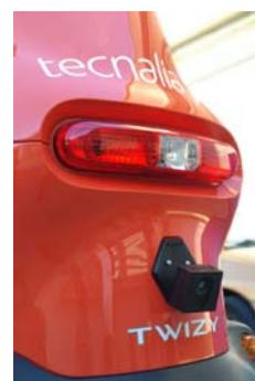
Figura 8: Plataforma experimental de Tecnalía: Renault Twizy con cámara ToF.
