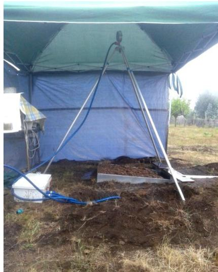
**Figura 3.** Simulador de lluvia instalado sobre una microparcels
