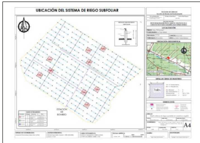
Figura 13. Sistema de riego subfoliar sin cobertura vegetal y ubicación de las áreas experimentales. Finca La Fátima.
