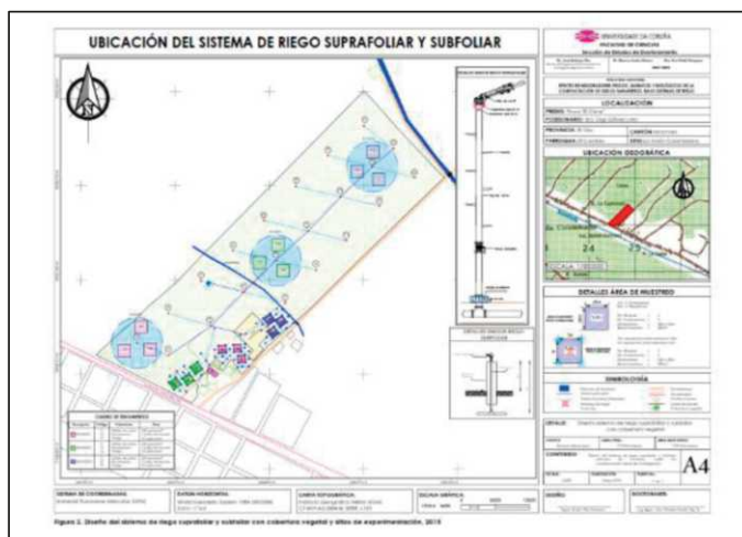
Figura 11. Sistema de riego suprafoliar y subfoliar con cobertura vegetal, y ubicación de las áreas experimentales. Finca El Cisne.
