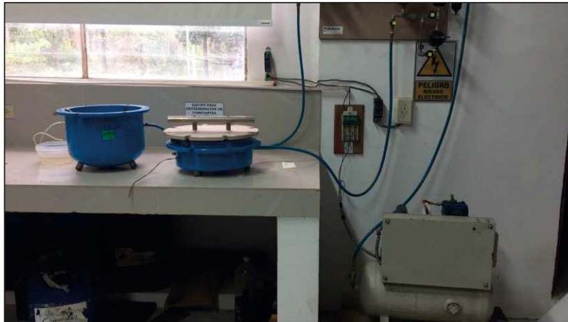
Figura 16. Pruebas de constantes hidrofísicas, ollas de presión y membranas de Richards.
