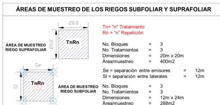
Figura 14. Dimensiones de las áreas de muestreo en los riegos subfoliar y suprafoliar de las fincas.
