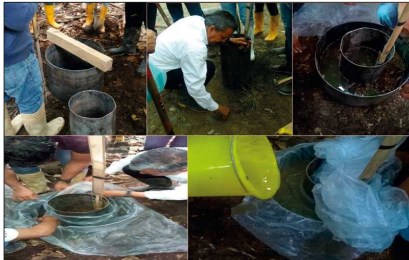
Figura 19. Pruebas de infiltración en campo.
