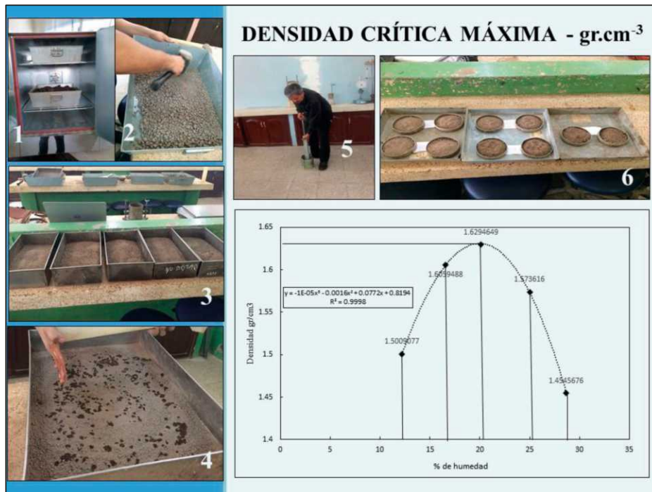
Figura 18. Prueba Proctor en compactación inducida del suelo.
