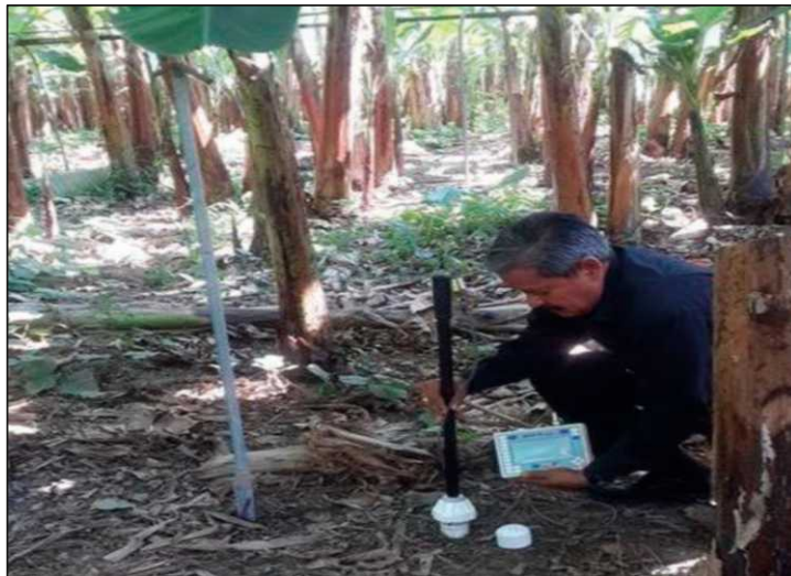
Figura 17. Toma de datos con la sonda FDR.
