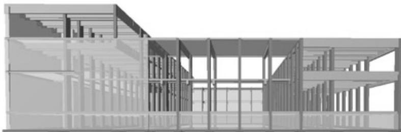
*Modelado planta de forjado sanitario.*
