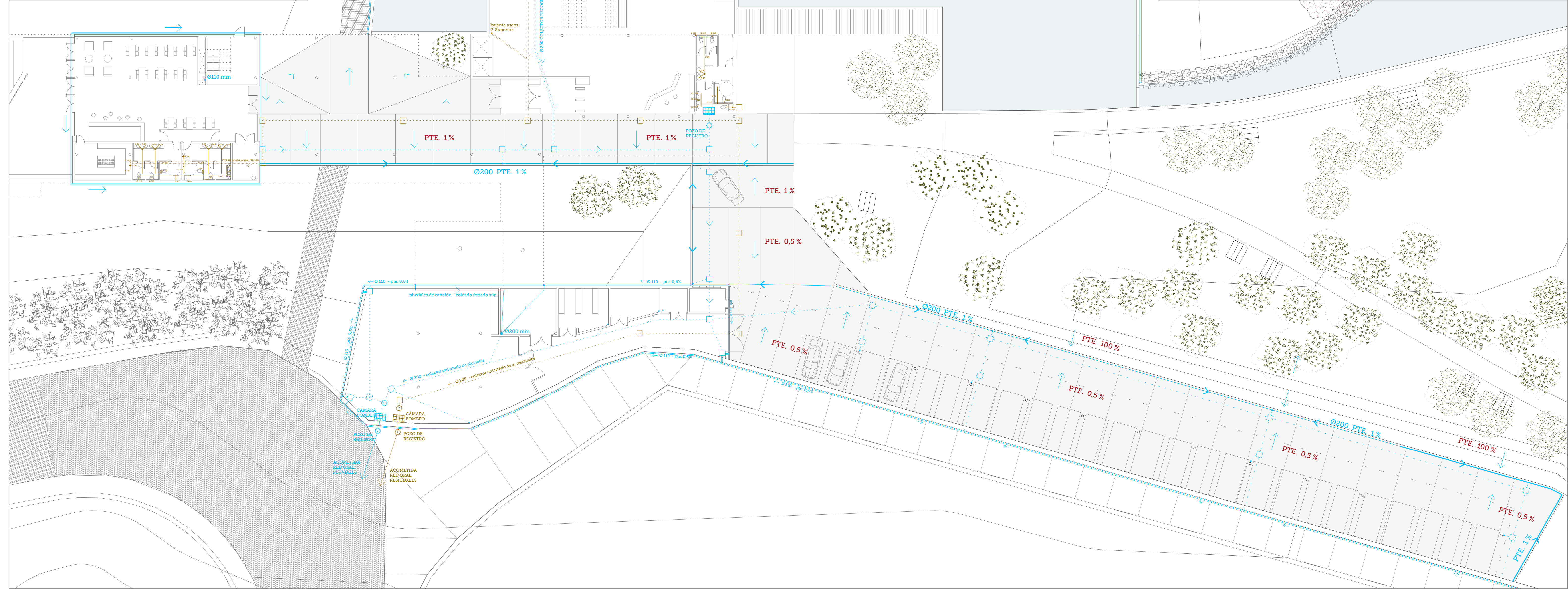
PLANTA ACCESO: Recogida de aguas pluviales y residuales E: 1/200 0 2 4 8 m
