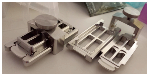
Figura 5. Cámara de hibridación. Á dereita aberta e á esquerda pechada co portaobxectos e o cubreobxectos dentro.
