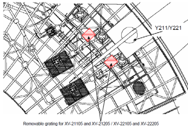
Imagen 17. Identificación de componentes del suelo removibles de la plataforma de un tanque de GNL
