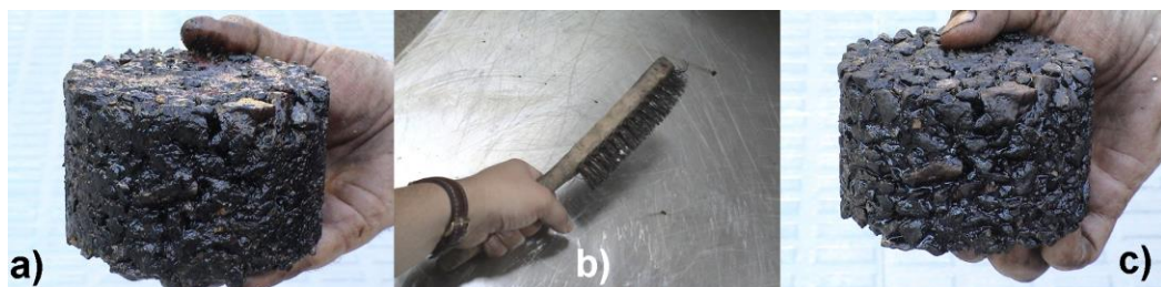
Figura 3. a) Probeta después de inmersión; b) cepillo metálico; la misma probeta después de cepillado
