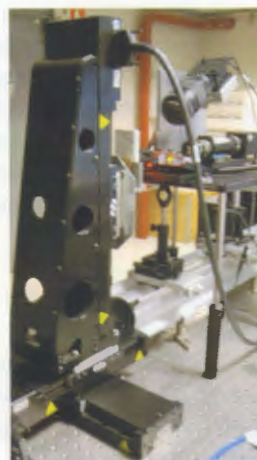
Figura 1. Fotografía e esquema do sistema utilizado para procesar con láser materiais con superficies non planas.
