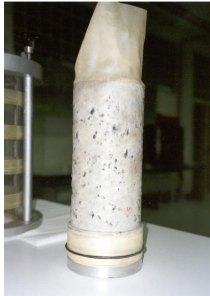
Figura 4. Probeta compactada antes de la colocación de la segunda membrana.
