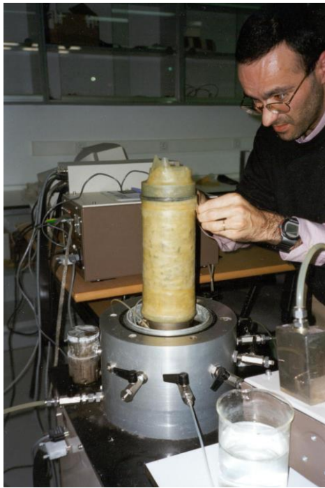
Figura 5. Colocación de la probeta en el equipo triaxial.
