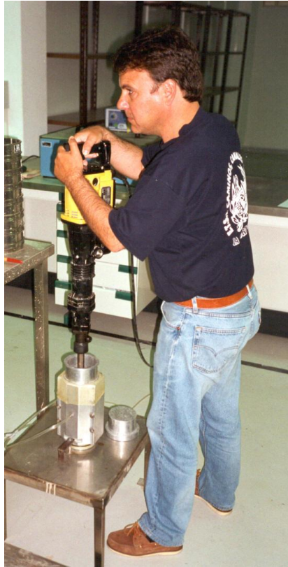
Figura 3. Compactación de la probeta.
