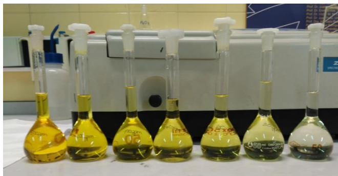
Figura 10: Disolucións de Cr (VI) de diferentes concentracións para os experimentos da isoterma
