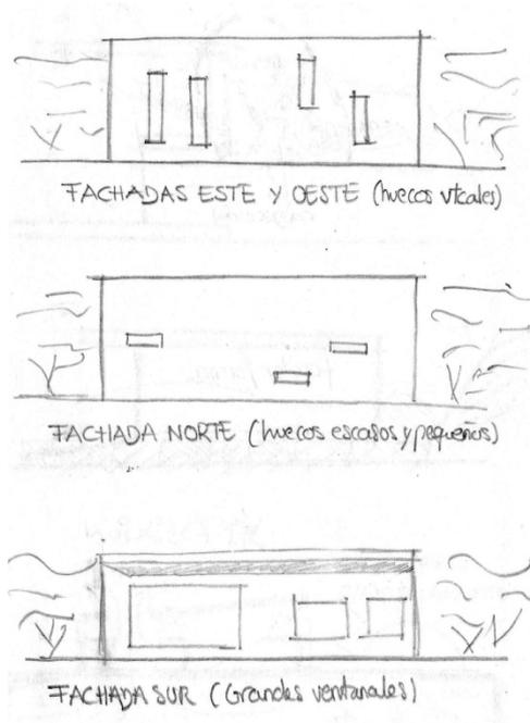
Figura 29- Criterio de diseño de huecos en función de la orientación. Fuente: elaboración propia.
