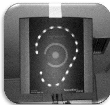
Figura III: Señal luminosa que mide el nivel de ruido en la unidad neonatal. (UCIN del CHUF)
