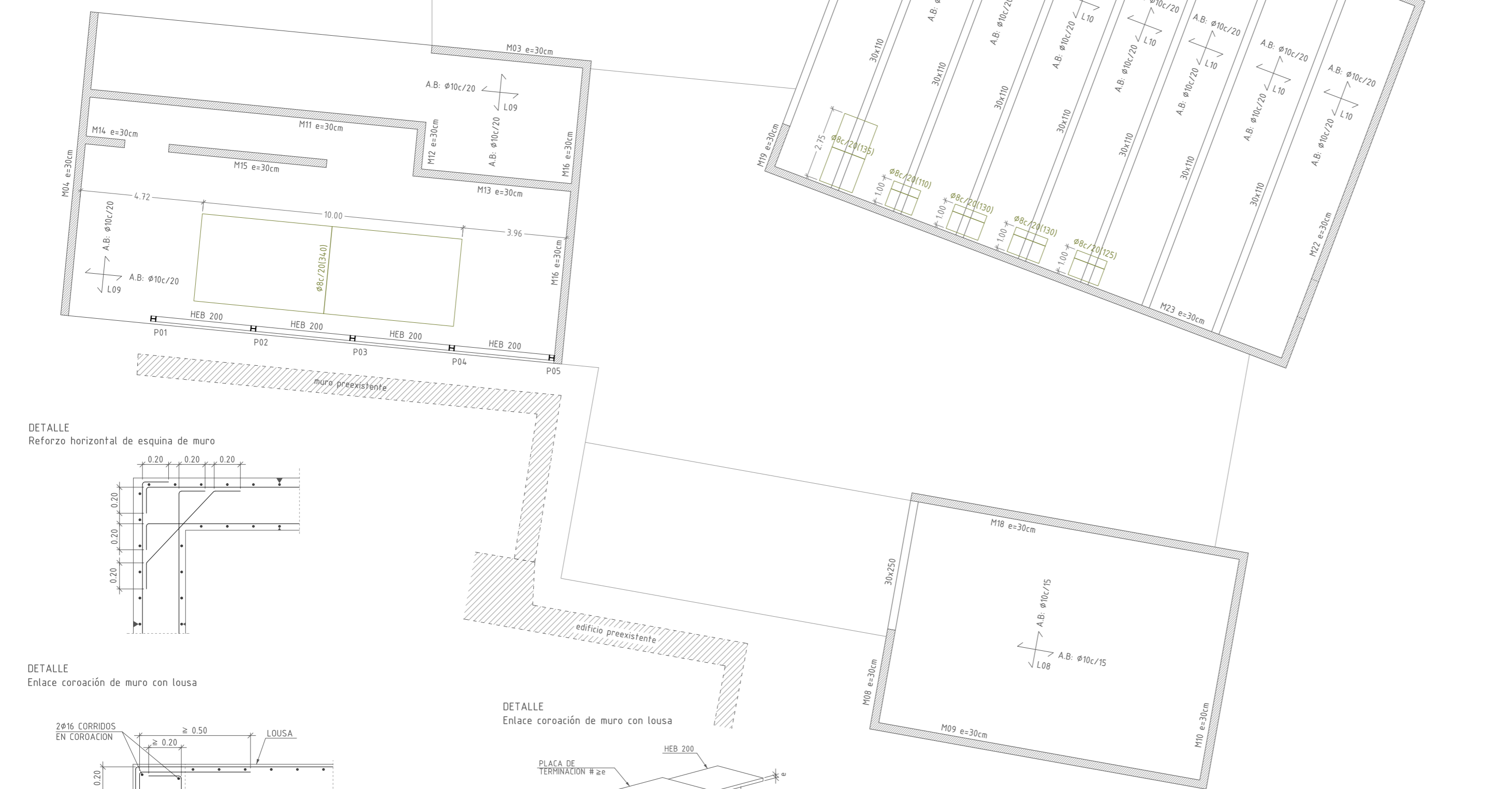
DETALLE Greca antipunzonamento Ø8c/16
