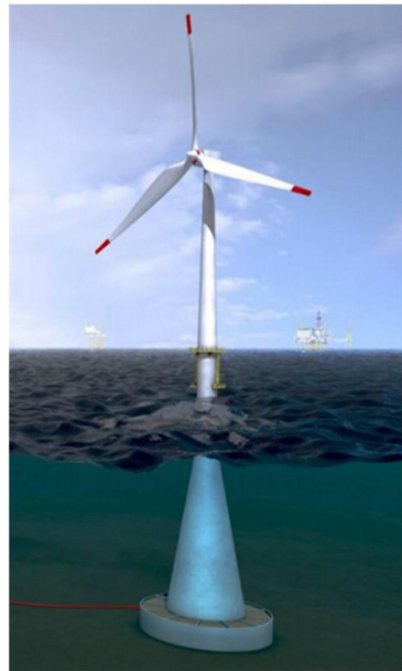
Ilustración 4. Estructura gravitatoria (Profundidad < 30 metros).
