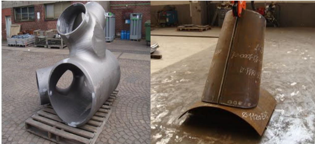
Ilustración 17. Nudos de fundición (izquierda) y soldado (derecha).
