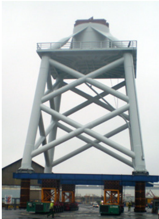
Ilustración 7. Estructura tipo jacket (40 < profundidad < 70 m).
