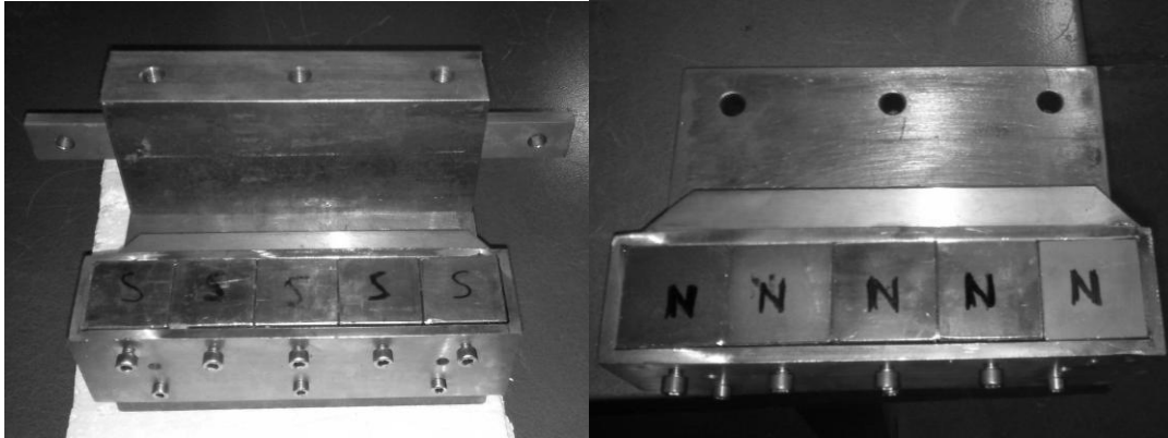
Fig. 4.12. Disposición del ensamblaje simple de imanes permanentes.
