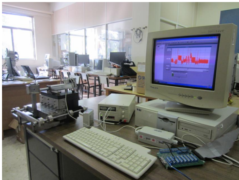
Fig. 4.21. Fotografía tomada durante las pruebas de medición y adquisición de datos de la fuerza necesaria para el desplazamiento del AMR.
